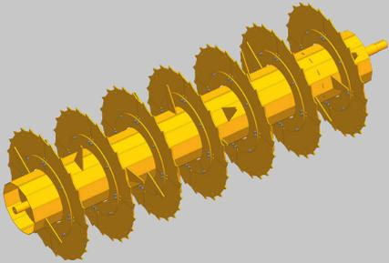
Picadores de accionamientos mecánico por juego de cadenas y perno de seguridad, están equipados con 7 discos dentados concebidos exclusivamente para el corte de la paja.
