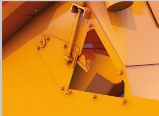
Pieza biselada ubicada en salida de la boca, este dispositivo asegura una salida de materia homogénea sin atasco.
