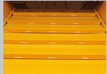
Accionado hidráulicamente, posee 9 velocidades de alcanza (adelante e atrás) para llevar con regularidad la materia a los picadores.
