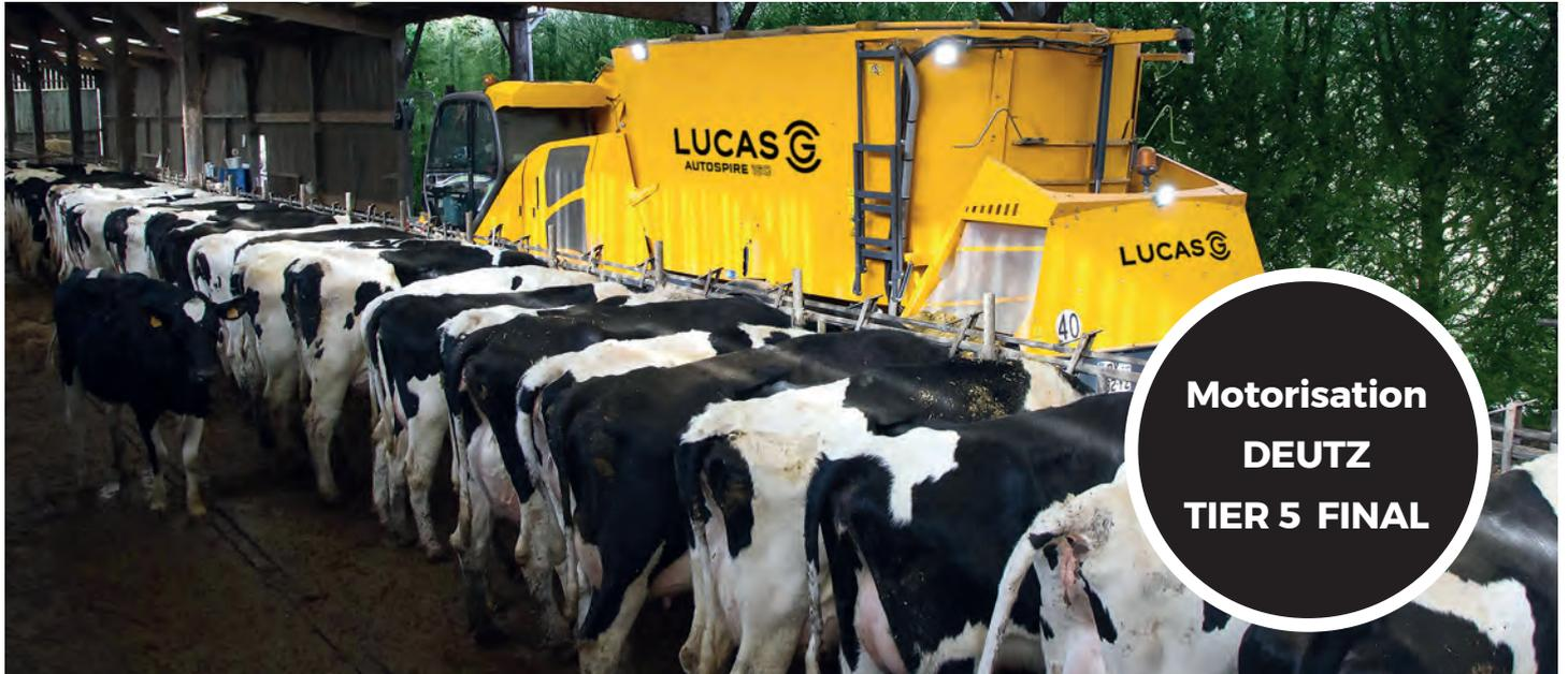
La mélangeuse automotrice Autospire a été conçue pour réaliser une tournée quotidienne de plus de 70 km par jour. Les machines sont équipées de pneus poids lourds larges et d'un système freinage à 4 freins à disque pour une tenue de route et une sécurité optimale à 40 km/h. La suspension hydropneumatique avant et par lame parabolique arrière procure souplesse et confort de conduite pour l'opérateur.
