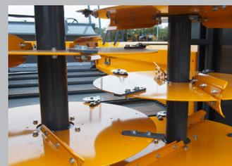
Rotors équipés de disques de paillage avec plateaux de projection superposés afin de canaliser et maîtriser le flux de paille.
