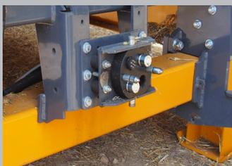
Connecteur mâle situé au niveau du cadre du pique à balle, il permet de piloter l'ensemble des fonctions hydrauliques de la machine sans avoir à descendre du télescopique.
