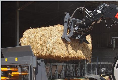
Accessoire pour la manutention des balles rondes et carrées, il est équipé de 2 dents de 130 cm Ø 40 mm et d'une entraxe de 90 cm entre les deux dents.
